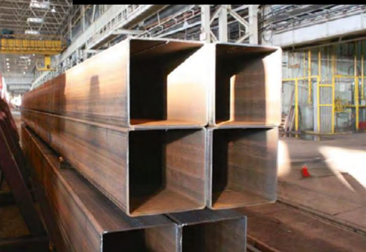
Уралтрубпром выполнил заказ по производству электросварных профильных труб размером — 450×450×8 мм. Продукция предназначена для оснащения конвейера по сборке прицепов на производственной площадке в городе Тольятти.
